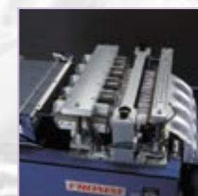
Ar comprimido – termo-soldagem – perfuração
