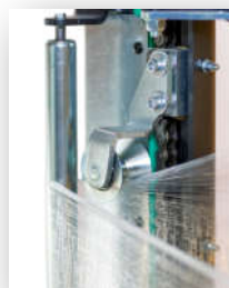
Sistema de cordão, com acionamento por corrente
